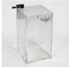
Récipient en verre stable avec noix, pour la fixation du manoscope ( 361 57 ) à différentes profondeurs d'immersion.
