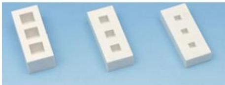
Moules pour réaliser des éprouvettes cubiques de trois tailles différentes en plâtre, béton, etc. pour des essais de compression avec la presse hydraulique ( 36110 ).
