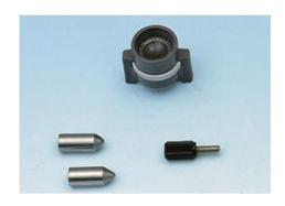
Billes d'acier montées dans un support à visser pour mesurer la dureté des métaux avec la presse hydraulique ( 36110 ).
