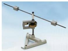
Pour l'étude des oscillations de torsion et la détermination des moments d'inertie de différents corps d'essai à partir de la période d'oscillation.
