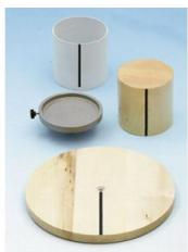
Pour déterminer expérimentalement les moments d'inertie.
