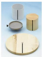
Pour déterminer expérimentalement les moments d'inertie.
