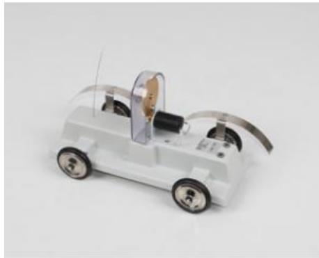
Pour illustrer les phénomènes de résonance. Châssis en plastique sur quatre roues avec suspension, garde-boue et antenne. Excitation de la résonance par un moteur électrique fixe avec volant et excentrique.
