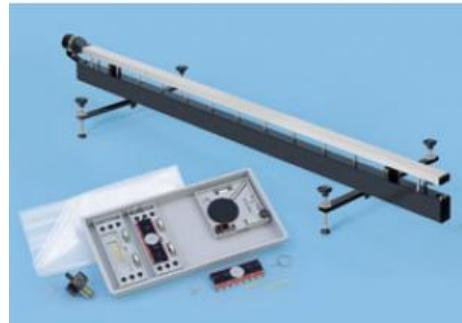
**Banc à coussin d'air, complet, avec 2 mobiles et tampons pour chocs, électro-aimant, masse**
