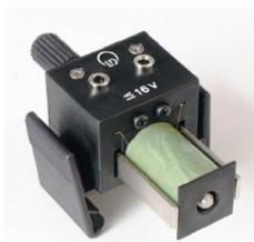
Électro-aimant permettant de déclencher un déplacement à un moment précis, par ex. à l'aide de l'adaptateur pour aimant de maintien avec déclencheur ( 336 25 ) ; avec noyau de fer à réglage axial pour la réduction des retards à l'aimantation.
