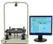
Le système de contrôle à billes et plaques est commandé par NI LabView et démontre un problème de contrôle classique: équilibrer une sphère sur une surface plane et maintenir sa position (version NI LabVIEW, y compris la carte d'interface NI LabVIEW et le câble).
