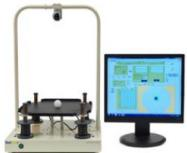
Le système de contrôle à billes et plaques est commandé par NI LabView et démontre un problème de contrôle classique:
