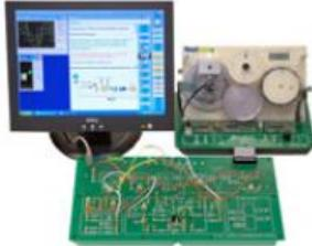
Ce simulateur permet d'examiner les bases de la technique de commande à l'aide d'un moteur à courant continu et des capteurs.
