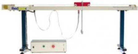
Le pendule numérique est une version moderne d'un problème de contrôle classique: le redressement et la stabilité d'un pendule à oscillation libre (pendule inversé) ou le contrôle de mouvement d'un pendule suspendu (application pour MATLAB, avec carte d'interface MATLAB et câbles)
