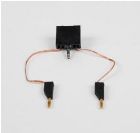
Le support de boucle permet de relier le capteur de forces (524060) et les boucles conductrices (51634). Il est constitué de deux douilles de 2 mm avec lamelle interne, d'une prise de fixation et de deux torons de cuivre très flexibles pour l'alimentation en tension et en courant.
