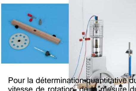
Pour la détermination quantitative du bilan des puissances, du freinage mécanique, de la mesure sans contact de la vitesse de rotation, de la mesure du débit et de la température du flux d'eau de refroidissement ainsi que pour la compensation électrique de la puissance frigorifique.
