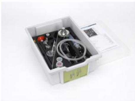
Équipement complémentaire pour la réalisation d'expériences fondamentales en chaleur et hydrostatique, par ex. pour l'étude des thèmes suivants : mesure de la température, dilatation, convection thermique et pression hydrostatique, poussée verticale, pompe à eau, effet capillaire ; dans boîte en plastique avec couvercle et insert thermoformé à la forme des composants.
