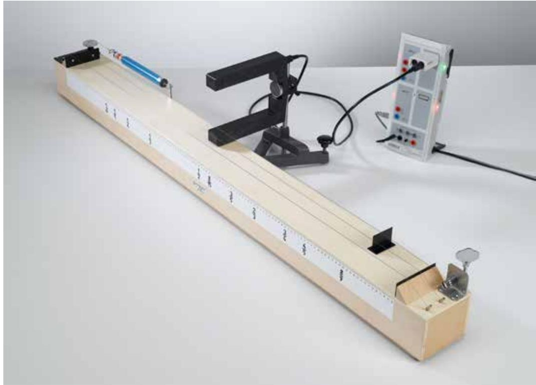
Détermination de la fréquence d'oscillation d'une corde en fonction de la longueur et de la tension de la corde (P1.7.2.1)
