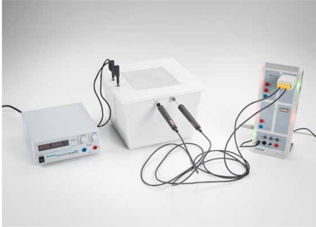
Détermination de la conductivité thermique de matériaux de construction selon le procédé à une plaque (P2.2.1.1)
