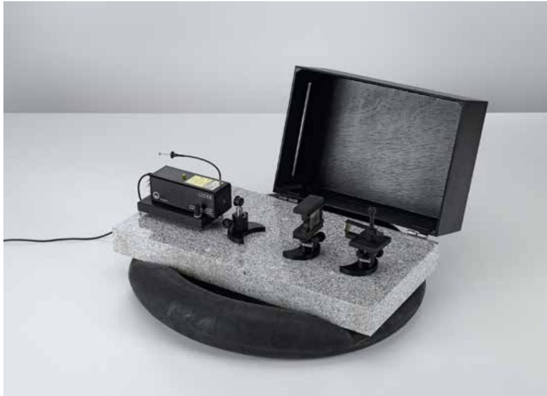
Réalisation d'hologrammes en lumière blanche par réflexion sur la plaque de base pour optique laser (P5.3.6.1)
