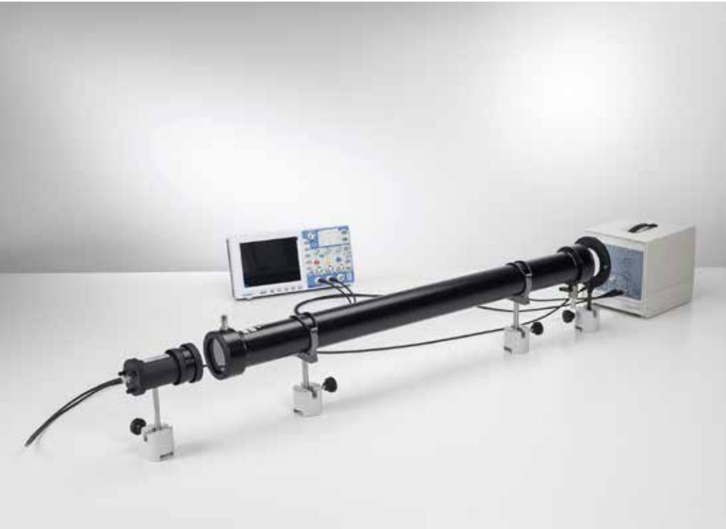
Détermination de la vitesse de la lumière dans différents milieux de propagation (P5.6.3.2)
