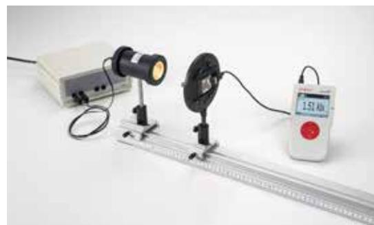
Détermination de l'intensité lumineuse en fonction de la distance à la source lumineuse - Mesure avec Mobile-CASSY (P5.5.1.2).
