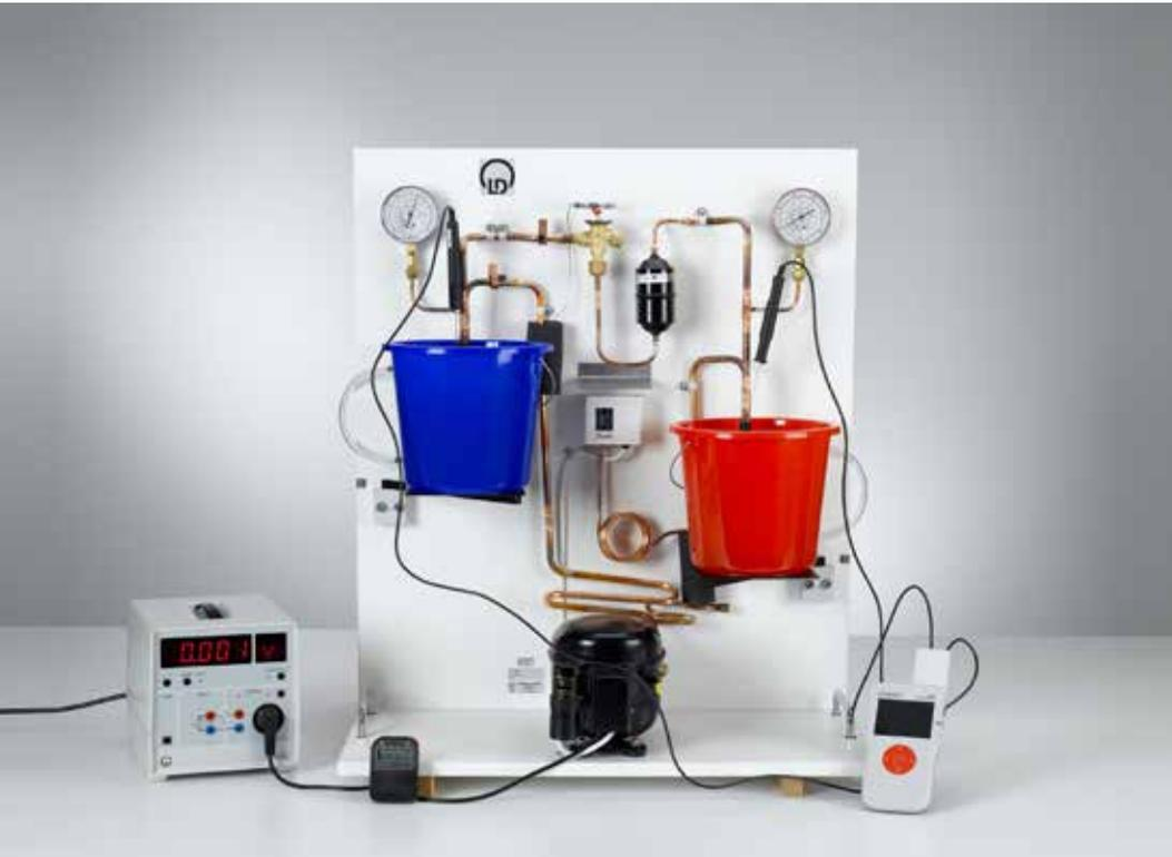
Détermination du coefficient d'efficacité de la pompe à chaleur en fonction de la différence de température (P2.6.3.1)
