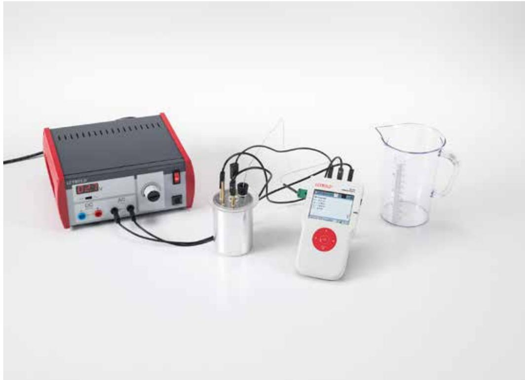
Détermination de la puissance de chauffage d'une charge ohmique dans un circuit à courant alternatif en fonction de la tension appliquée (P3.6.6.1)
