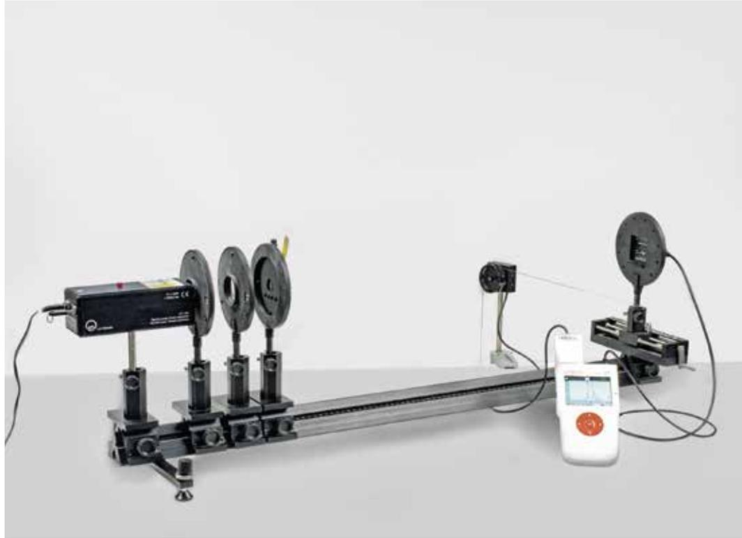
Diffraction par une fente simple - tracé et évaluation avec CASSY (P5.3.1.4)
