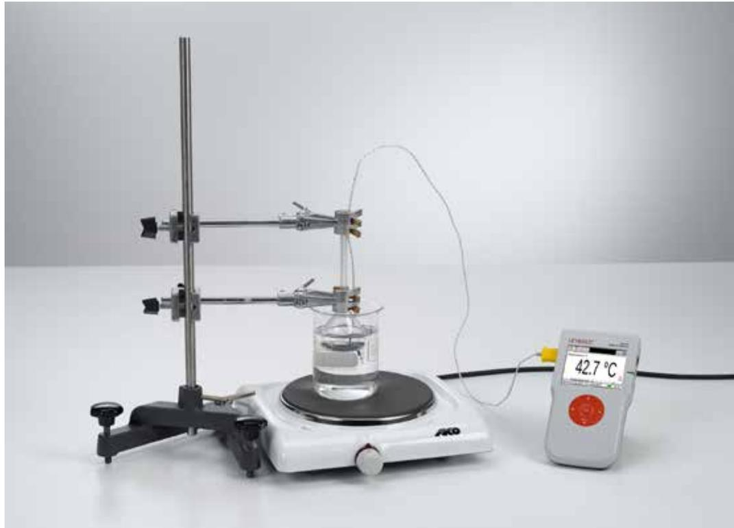
Détermination du coefficient de dilatation cubique des liquides - Mesure avec Mobile-CASSY (P2.1.2.2)
