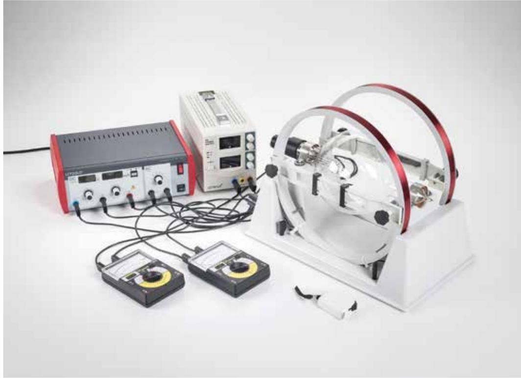
Détermination de la charge spécifique de l'électron (P6.1.3.1)
