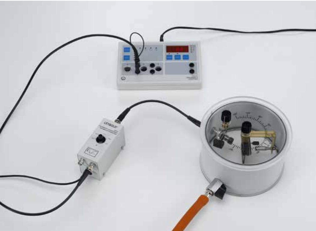
Diffusion de Rutherford : mesure du taux de diffusion en fonction de l'angle de diffusion et du numéro atomique (P6.5.2.1)
