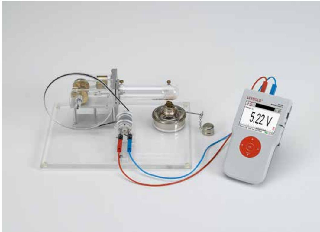
Le moteur à air chaud P utilisé comme moteur thermique, comme pompe à chaleur et comme machine frigorifique (P2.6.1.5)
