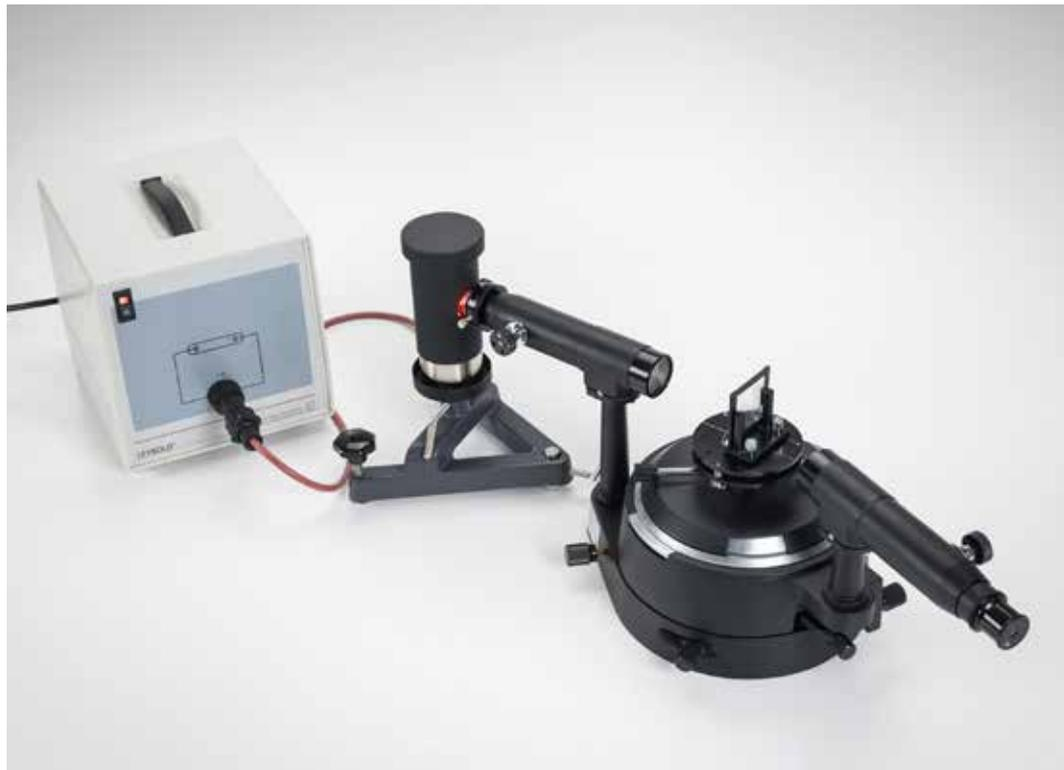
Mesure des spectres de raies de gaz rares et de vapeurs métalliques avec un spectromètre à réseau (P5.7.2.1)
