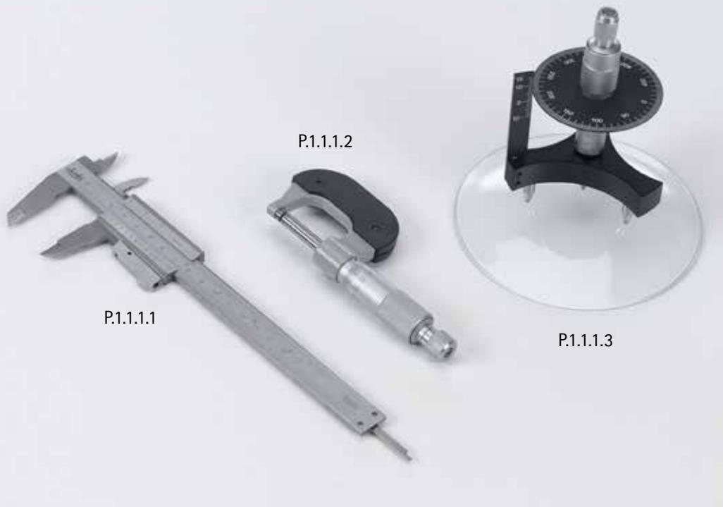
Emploi d'un sphéromètre pour la détermination des rayons de courbure (P1.1.1.3)
