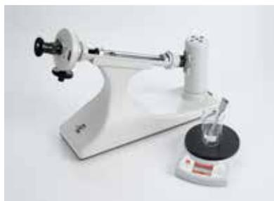
Détermination de la concentration de solutions de sucre avec un polarimètre de type commercial (P5.4.3.4)
