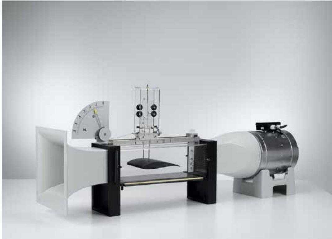
Mesures sur des profils d'aile dans le tunnel aérodynamique (P1.8.7.1)
