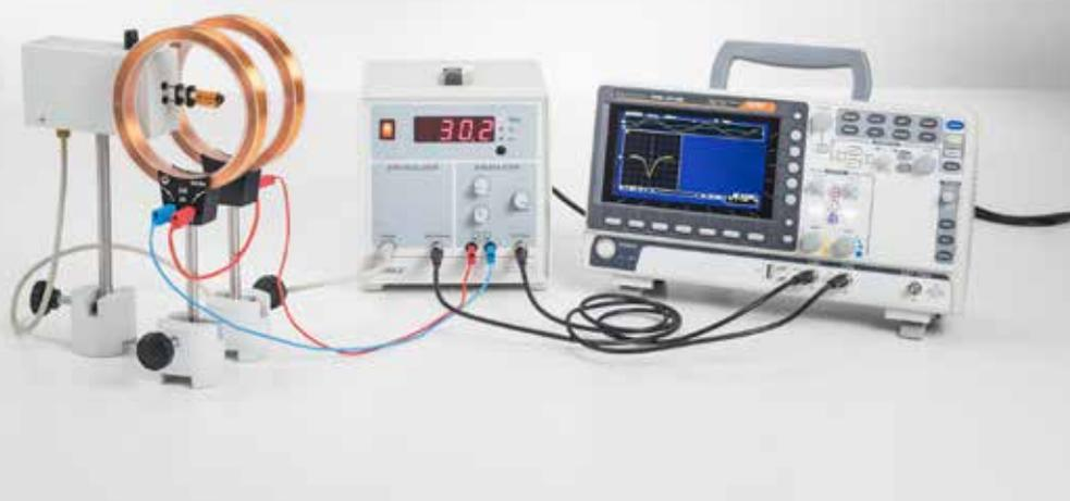
Résonance de spin électronique sur du DPPH - Détermination du champ magnétique en fonction de la fréquence de résonance (P6.2.6.2)
