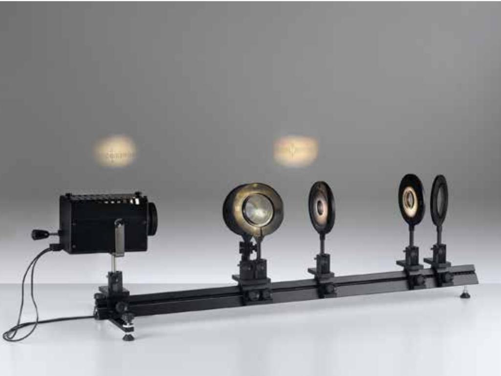
Les anneaux de Newton par transmission et réflexion avec une lumière blanche (P5.3.3.2)
