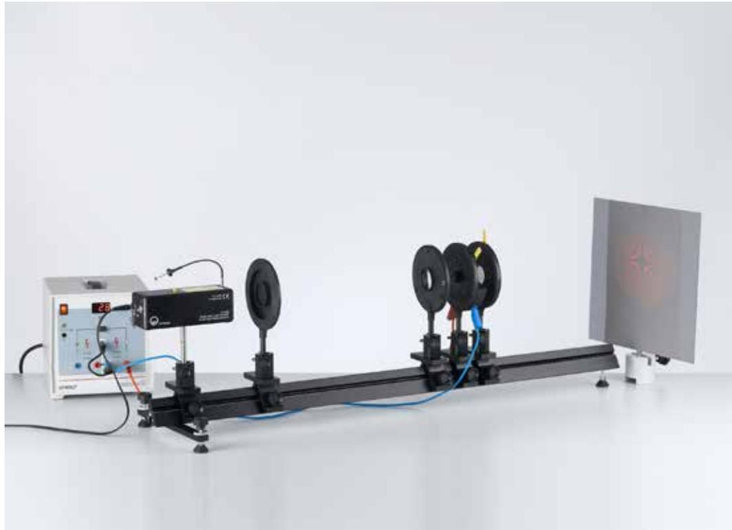
Démonstration de l'effet Pockels dans un trajet conoscopique du faisceau lumineux (P5.4.5.1)
