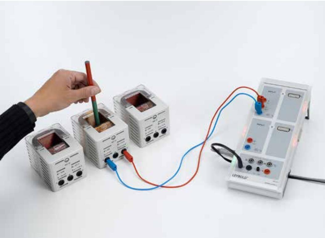
Génération d'un choc de tension dans une boucle conductrice avec un aimant permanent en mouvement (P3.4.1.1)
