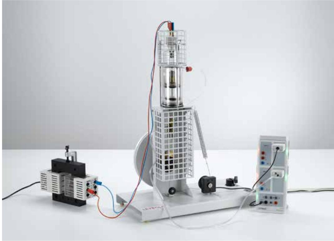
Diagramme pV du moteur à air chaud comme moteur thermique - tracé et exploitation avec CASSY (P2.6.2.4)
