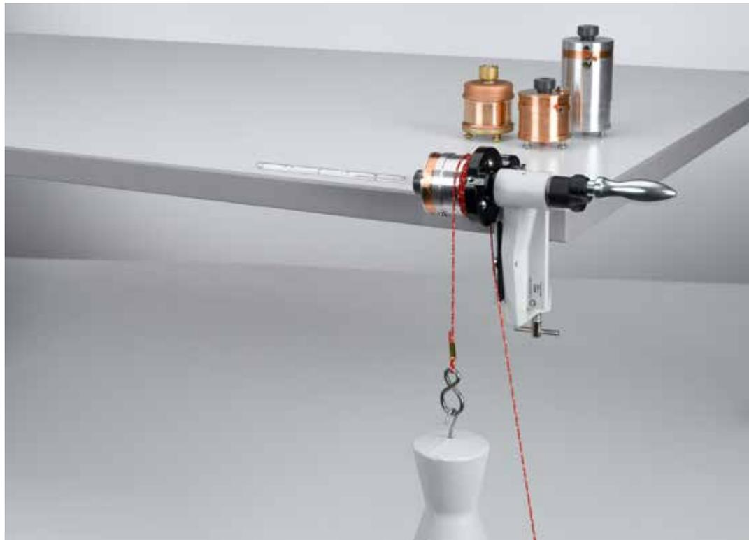
Transformation de l'énergie mécanique en énergie thermique - tracé et évaluation manuels des valeurs mesurées (P2.3.3.1)
