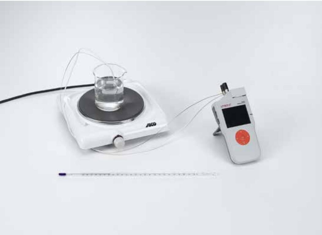
Effet Seebeck : détermination de la tension thermoélectrique en fonction de la différence de température (P7.2.5.1)
