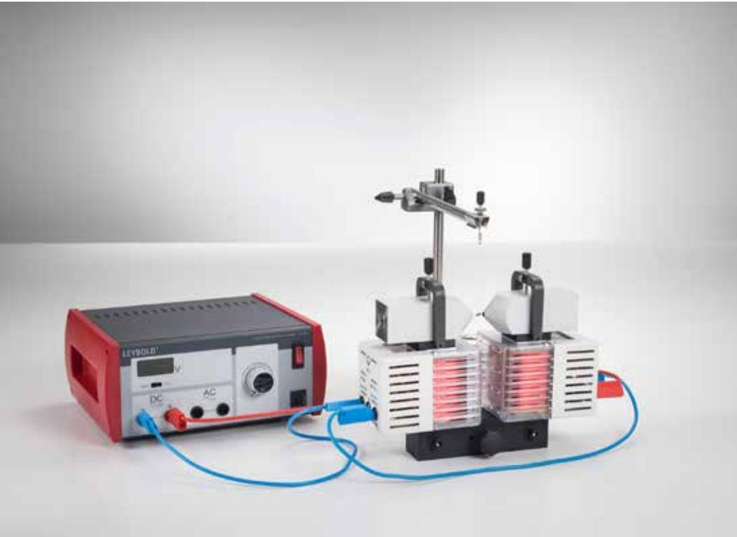
Substances diamagnétiques, paramagnétiques et ferromagnétiques dans un champ magnétique non homogène (P7.3.1.1)
