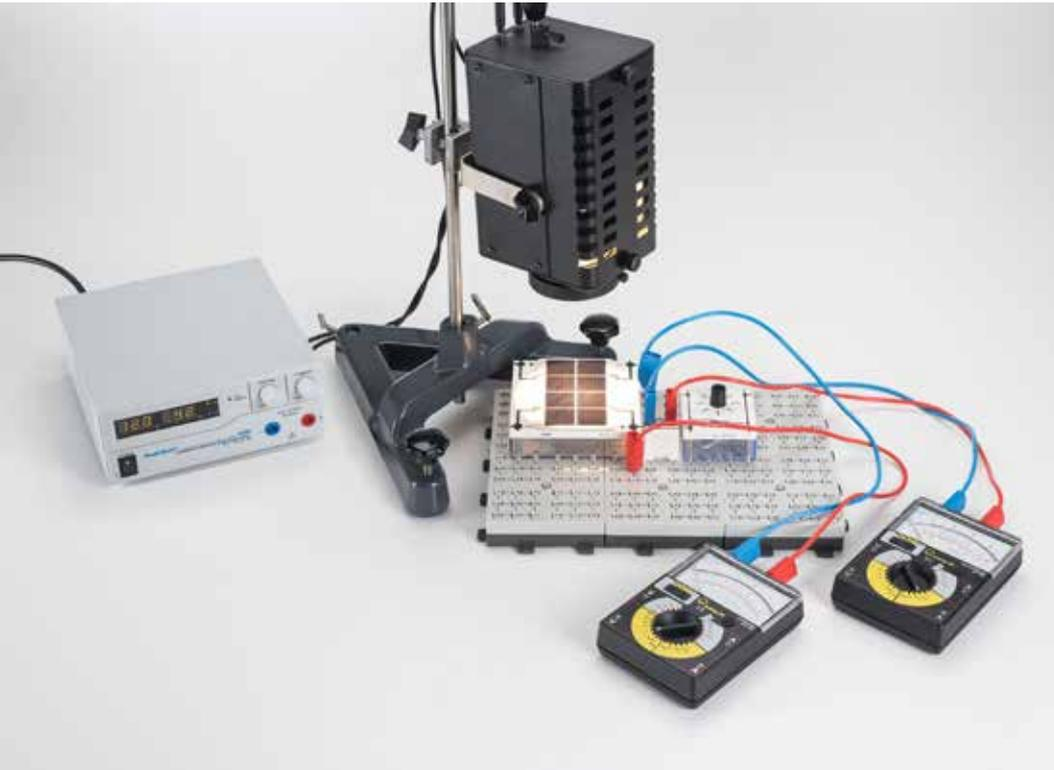
Relevé des caractéristiques courant / tension d'une batterie solaire en fonction de l'intensité lumineuse (P4.1.1.3)
