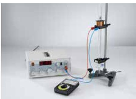
Détermination de l'exposant adiabatique  $c_p/c_v$  de divers gaz à l'aide de l'appareil de résonance élastique des gaz (P2.5.3.2).
