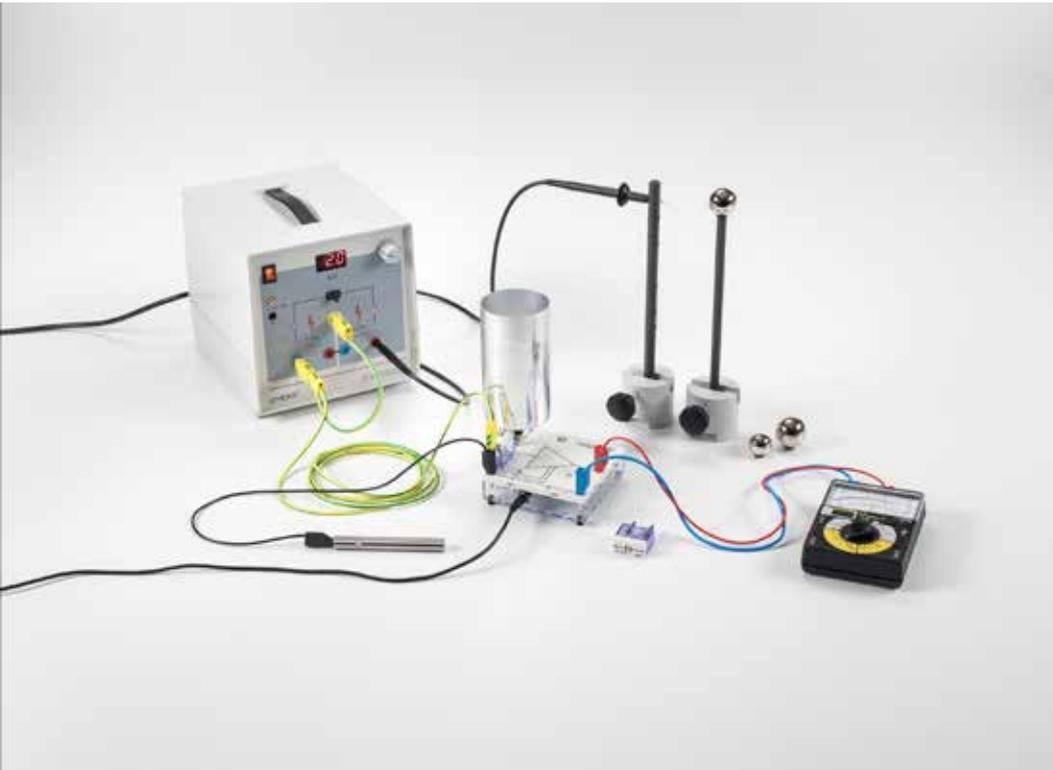
Détermination de la capacité d'une sphère dans un espace libre (P3.1.6.1)
