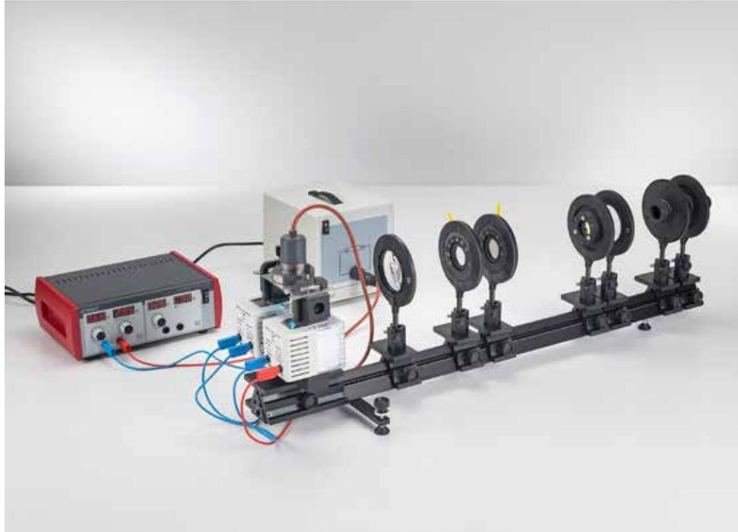
Observation de l'effet Zeeman normal dans une configuration transversale et longitudinale - Spectroscopie avec un étalon de Fabry-Pérot (P6.2.7.3)
