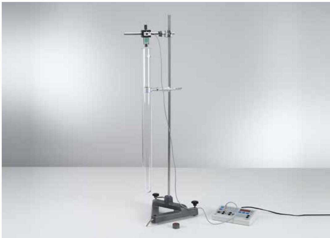
Construction d'un viscosimètre à chute de bille pour déterminer la viscosité de liquides visqueux (P1.8.3.1)
