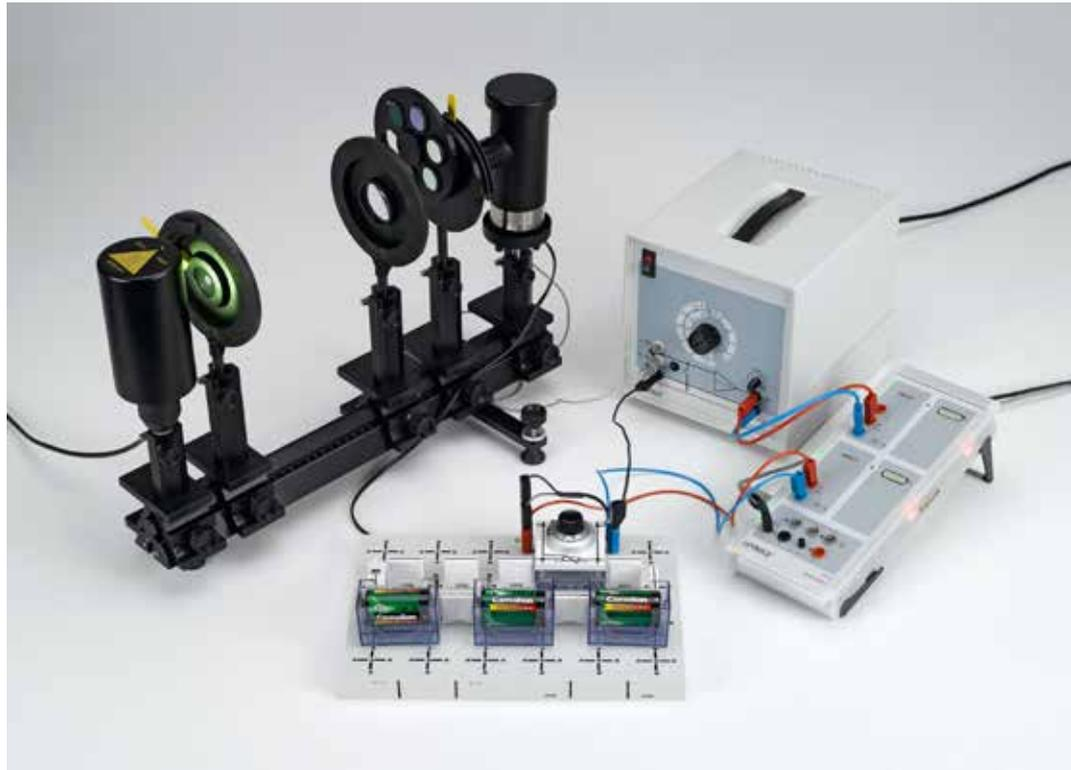
Détermination de la constante de Planck – Tracé de caractéristiques courant / tension, sélection de la longueur d'onde avec des filtres d'interférences sur le banc (P6.1.4.4)
