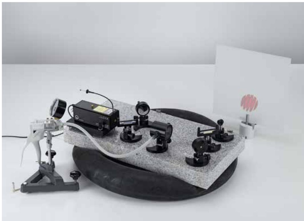
Mesure de l'indice de réfraction de l'air à l'aide d'un interféromètre de Mach-Zehnder (P5.3.5.2)
