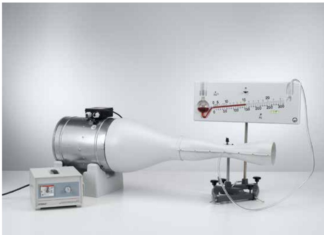
Pression statique et détermination de l'écoulement volumétrique avec un tube de Venturi - mesure de la pression avec le manomètre de précision (P1.8.5.1)
