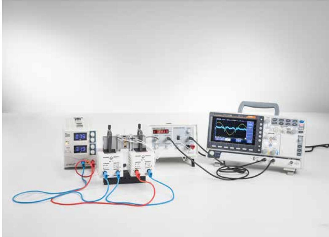
Résonance de spin nucléaire du polystyrène, de la glycérine et du téflon (P6.5.3.1)
