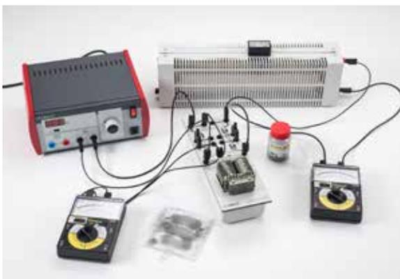
Transformation de la tension avec un transformateur en charge (P3.4.5.2).
