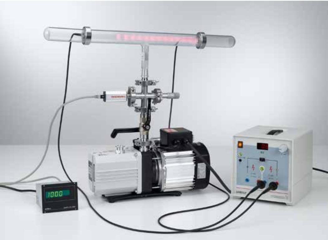
Étude de la décharge gazeuse autonome dans l'air en fonction de la pression (P3.9.2.1)
