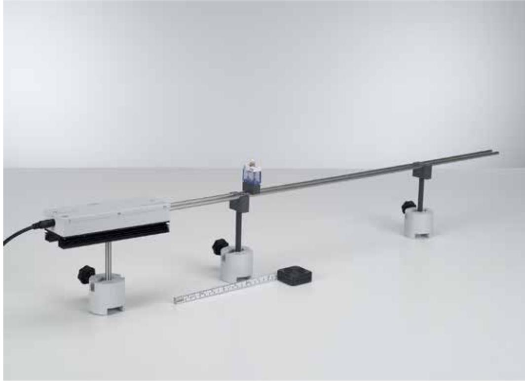
Détermination des maxima de courant et de tension sur une ligne de Lécher (P3.7.3.1)
