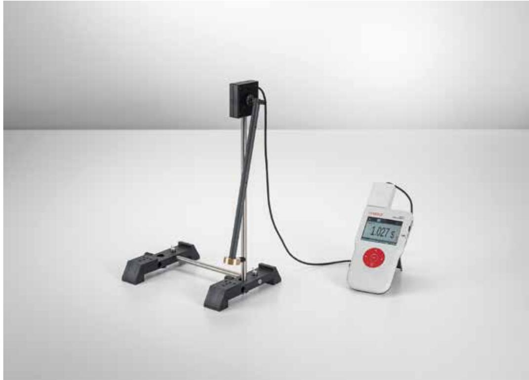
Oscillation d'un pendule composé et détermination de l'accélération de la pesanteur - Mesure avec capteur de rotation (P1.5.1.3)
