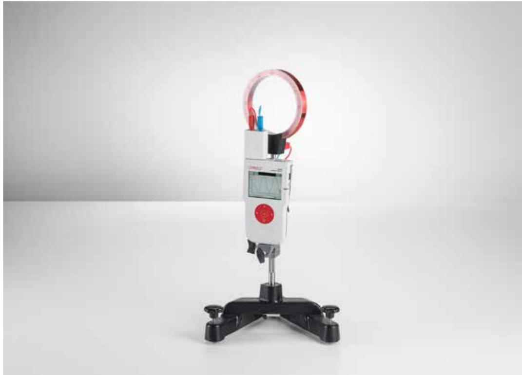
Mesure du champ magnétique terrestre avec une bobine d'induction en rotation et CASSY (P3.4.6.2)
