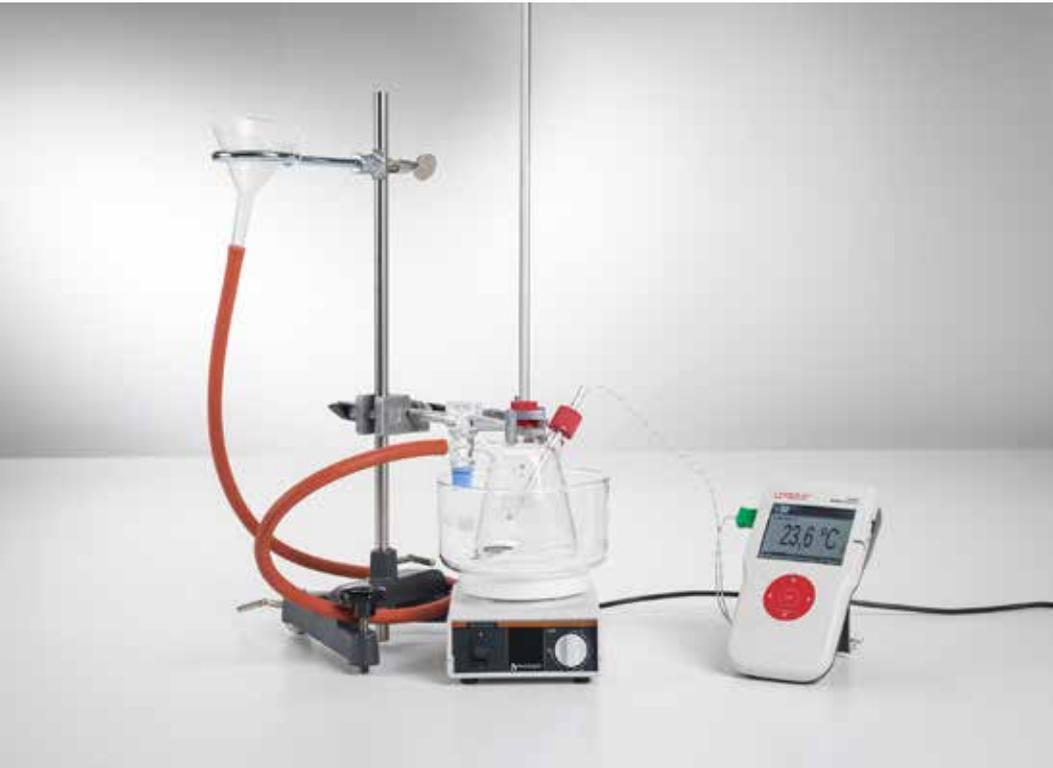
Etude de la densité maximale de l'eau - Mesure avec Mobile-CASSY (P2.1.3.2)
