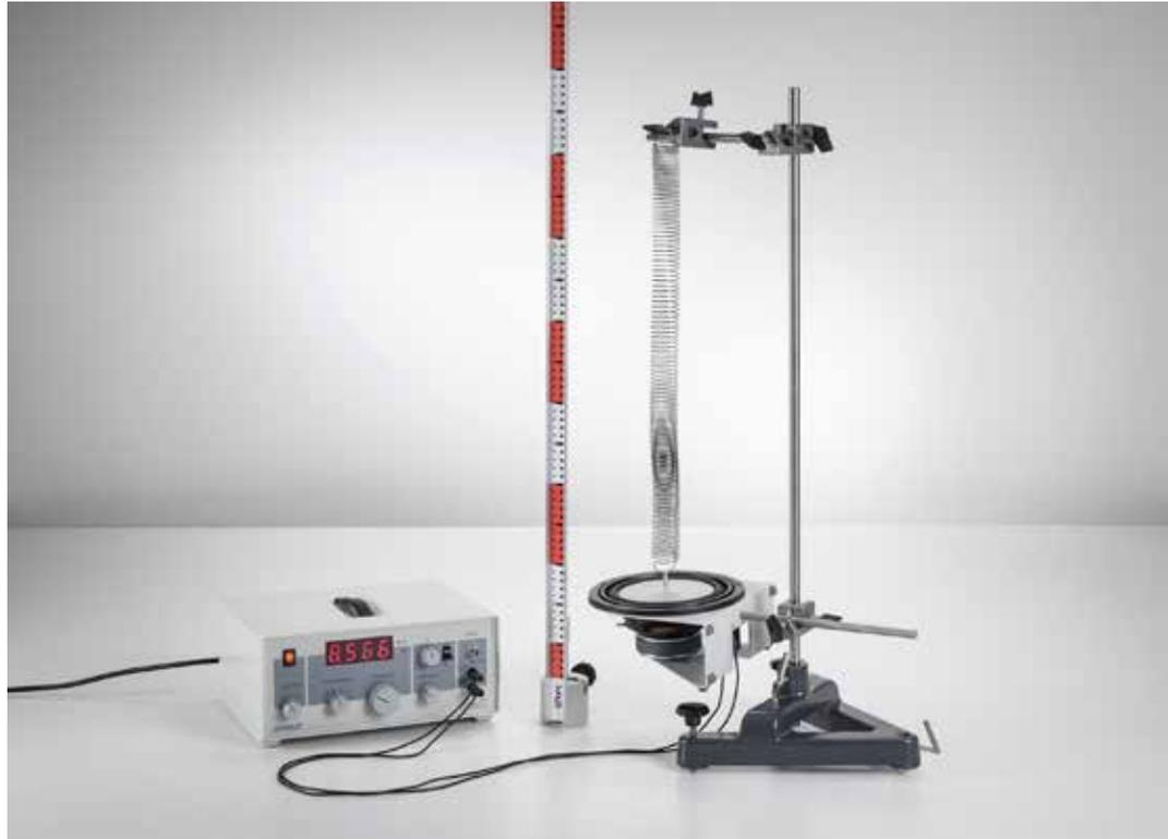
Génération de ondes stationnaires dans un ressort à boudin et la détermination de la longueur d'onde (P1.6.1.5)
