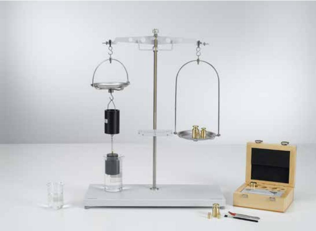
Vérification du principe d'Archimède (P1.8.2.1)
