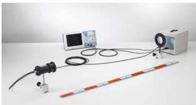
Déterminer la vitesse de la lumière en utilisant un signal lumineux périodique à une courte distance de mesure (P5 6 3 1).
