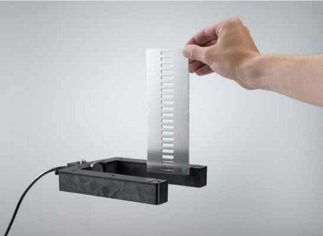
Chute libre: Mesure multiple du temps avec une échelle g (P1.3.5.3)
