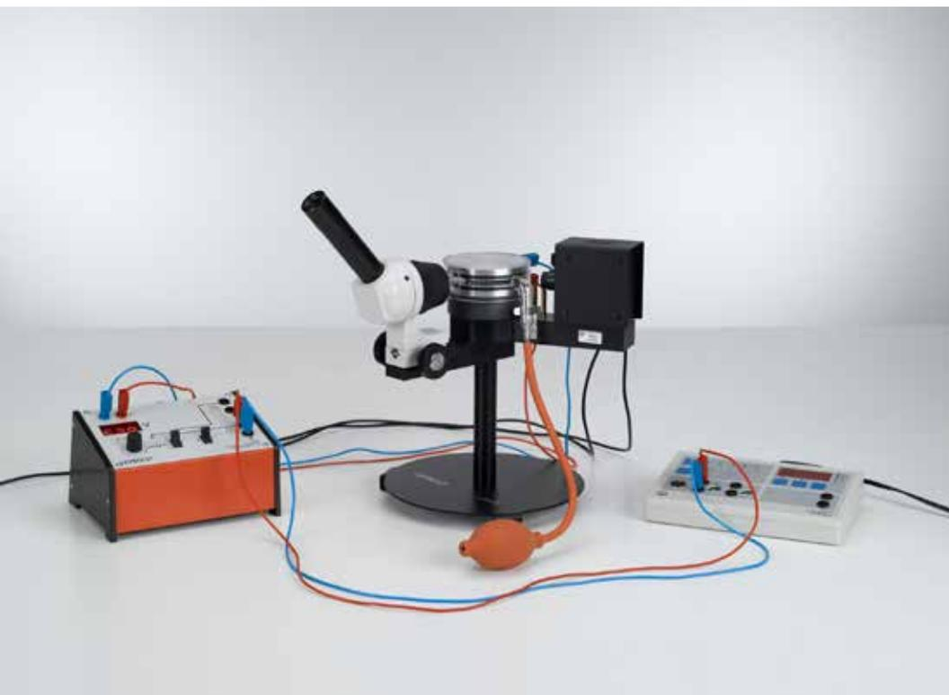
Détermination de la charge élémentaire électrique selon Millikan et mise en évidence de la quantification de la charge - Mesure de la tension flottante et de la vitesse de chute (P6.1.2.1)
