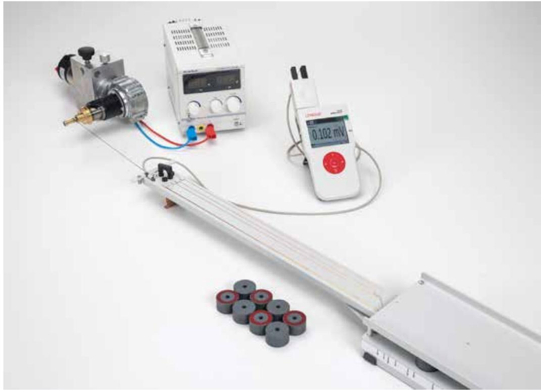
Mesure d'une force électromotrice induite dans une boucle conductrice déplacée à travers un champ magnétique (P3.4.2.1)
