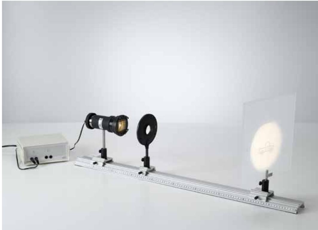
Vérification de la loi des lentilles avec une lentille convexe (P5.1.2.4)
