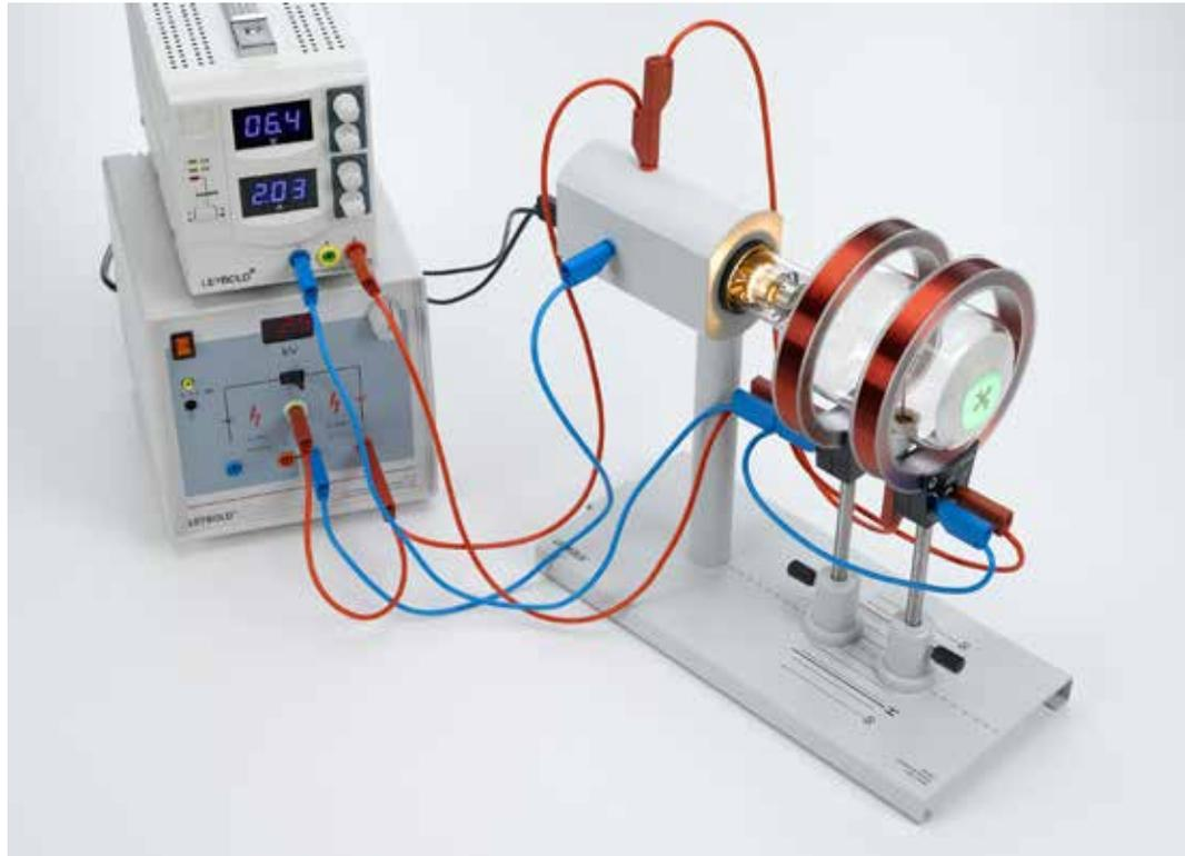
Déviations des électrons dans un champ magnétique axial (P3.8.3.2)
