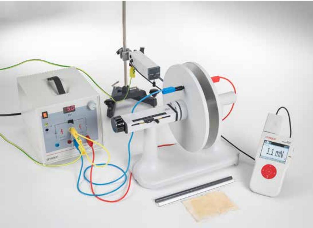
Mesure de la force exercée sur une charge électrique dans un champ électrique homogène - mesure avec le capteur de force (P3.1.4.4)
