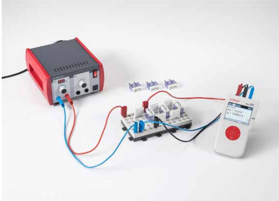
Mesure du courant et de la tension sur des résistances branchées en parallèle et en série (P3.2.3.1)
