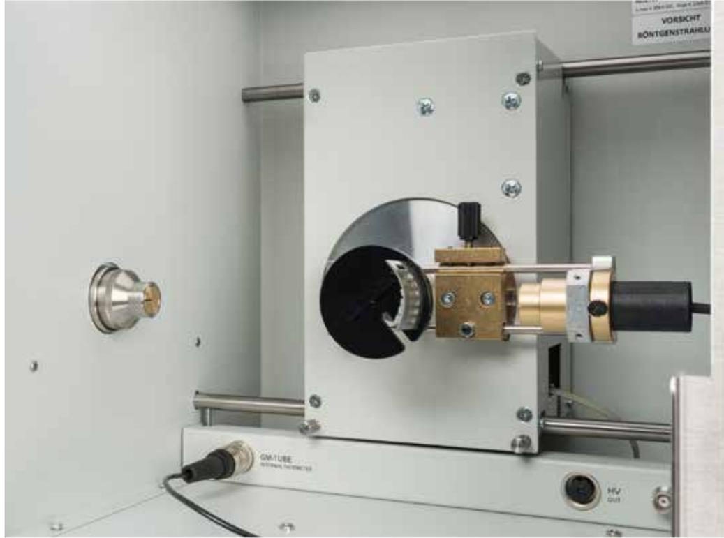
Étude de l'atténuation de rayons X en fonction du matériau d'absorption et de l'épaisseur d'absorption (P6.3.2.1)
