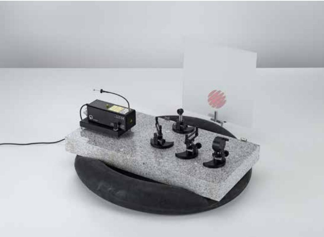
Détermination de la longueur d'onde d'un faisceau laser He-Ne à l'aide d'un interféromètre de Fabry-Perot (P5.3.5.3)
