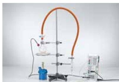
Enregistrement de la courbe vapeur-pression de l'eau - Pressions jusqu'à 1 bar (P2.4.2.1)
