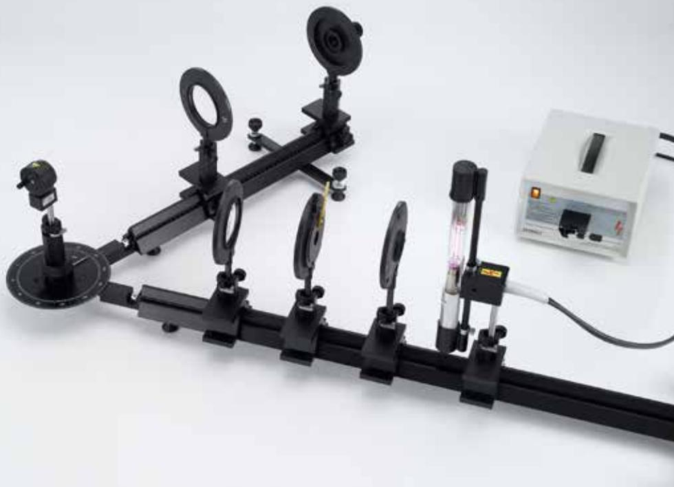
Observation du dédoublement des raies de Balmer dans le cas de la deutérum d'hydrogène (dédoublement isotopique) - Observation de la division de la ligne avec une construction de télescope (P6.2.1.5)
