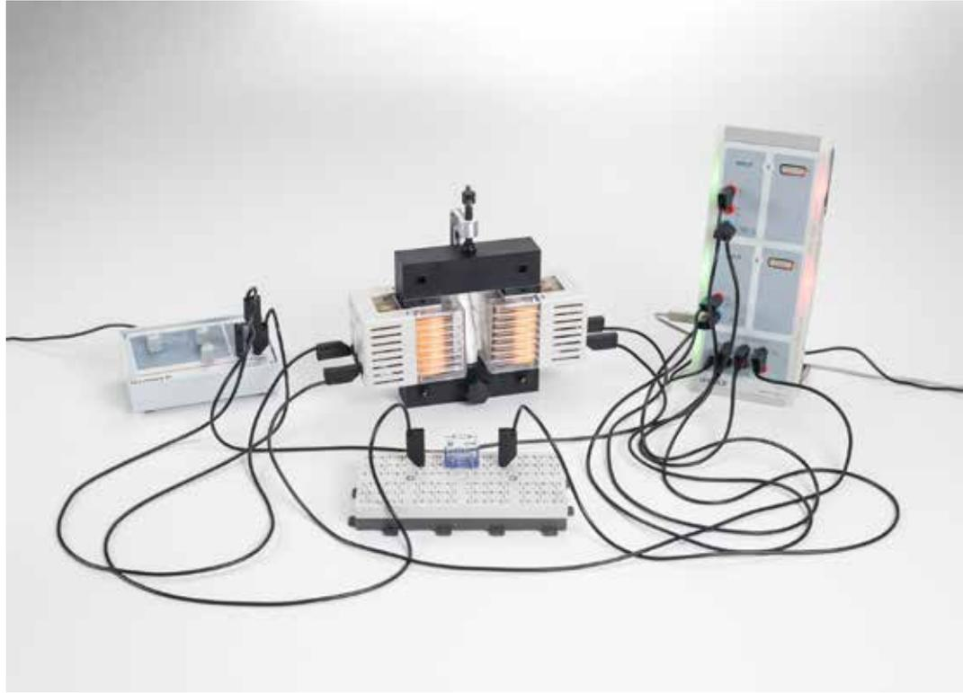
Tracé de la courbe de première aimantation et d'hystérésis d'une substance ferromagnétique et fer (P7.3.2.1)
