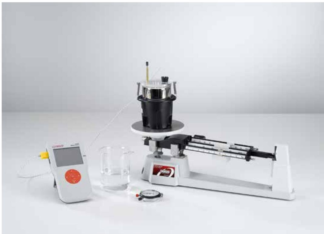
Mesure de température d'un mélange d'eau - Mesure avec Mobile-CASSY (P2.3.1.2)
