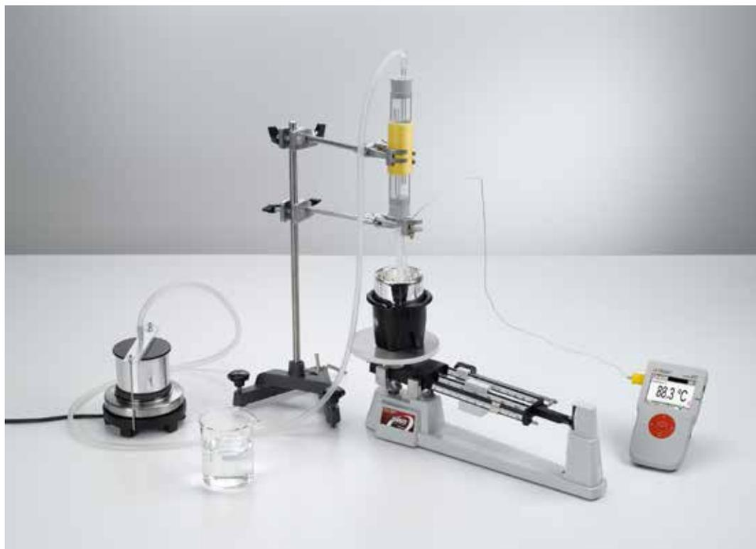
Détermination de la chaleur d'évaporation de l'eau - Mesure avec Mobile-CASSY (P2.4.1.3)
