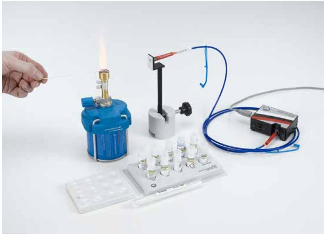
Enregistrement des spectres d'émission lors du test à la flamme (P6.2.2.4)
