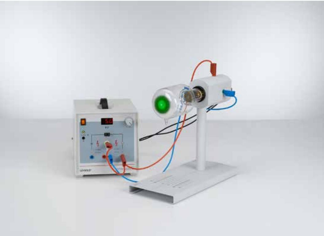
Diffraction d'un faisceau d'électrons par une structure polycristalline (diffraction de Debye-Scherrer) (P6.1.5.1)
