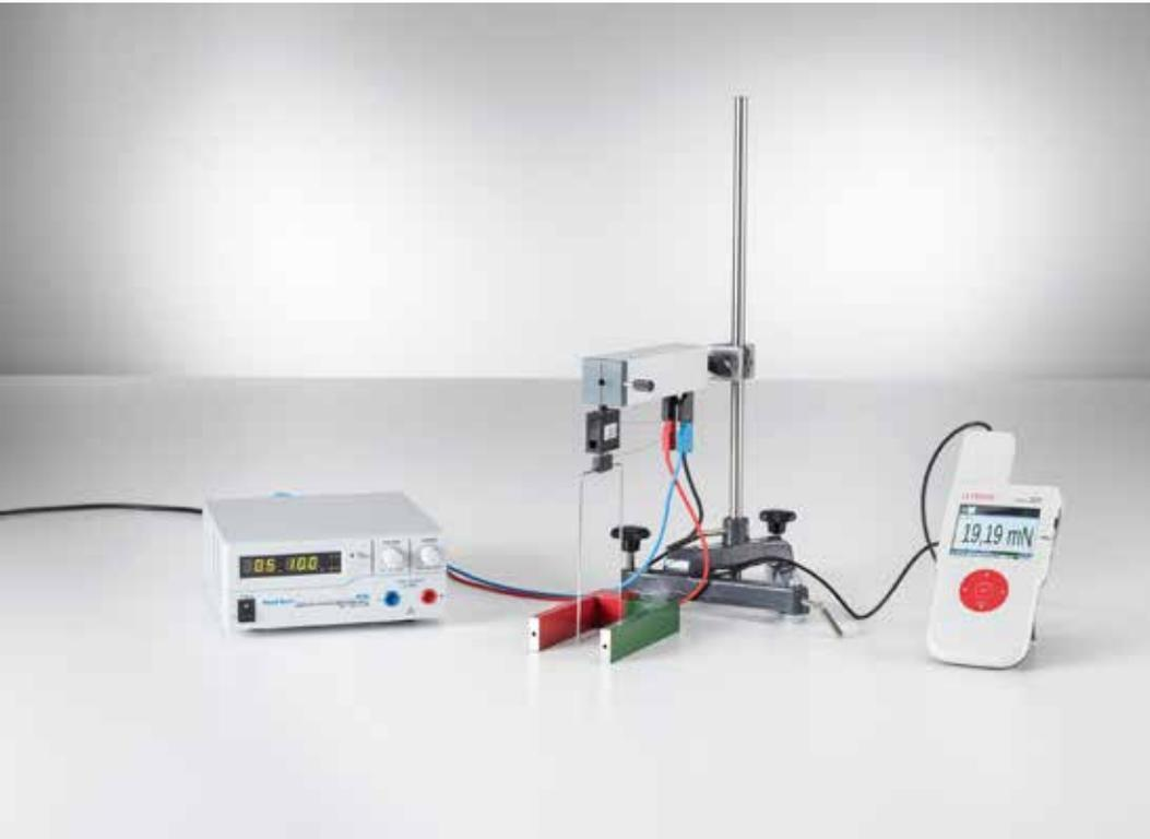
Mesure de la force sur des conducteurs parcourus par un courant dans le champ magnétique d'un aimant en fer à cheval (P3.3.3.1)
