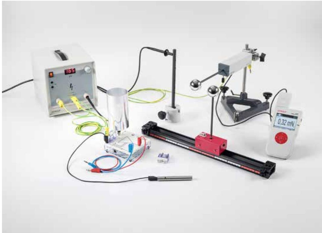
Vérification de la loi de Coulomb - mesure avec le capteur de force (P3.1.2.2)
