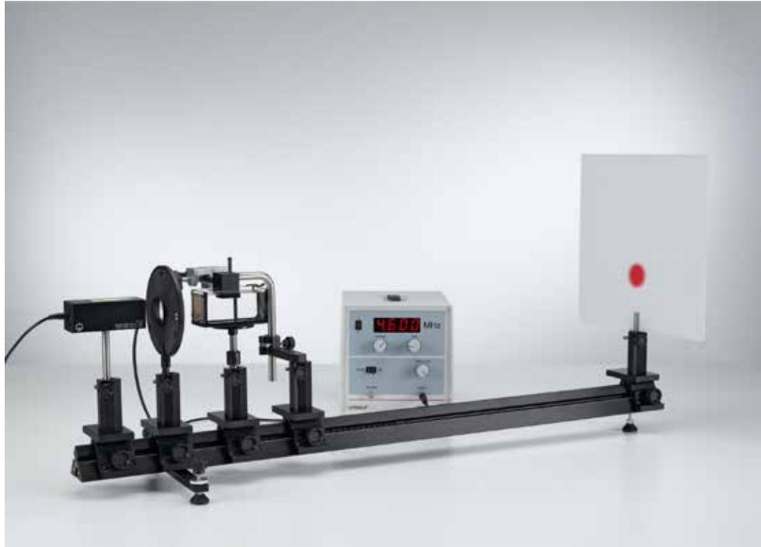
Détermination de la vitesse de son dans des liquides - ondes ultrasoniques stationnaires comme un réseau optique (P1.7.8.1)
