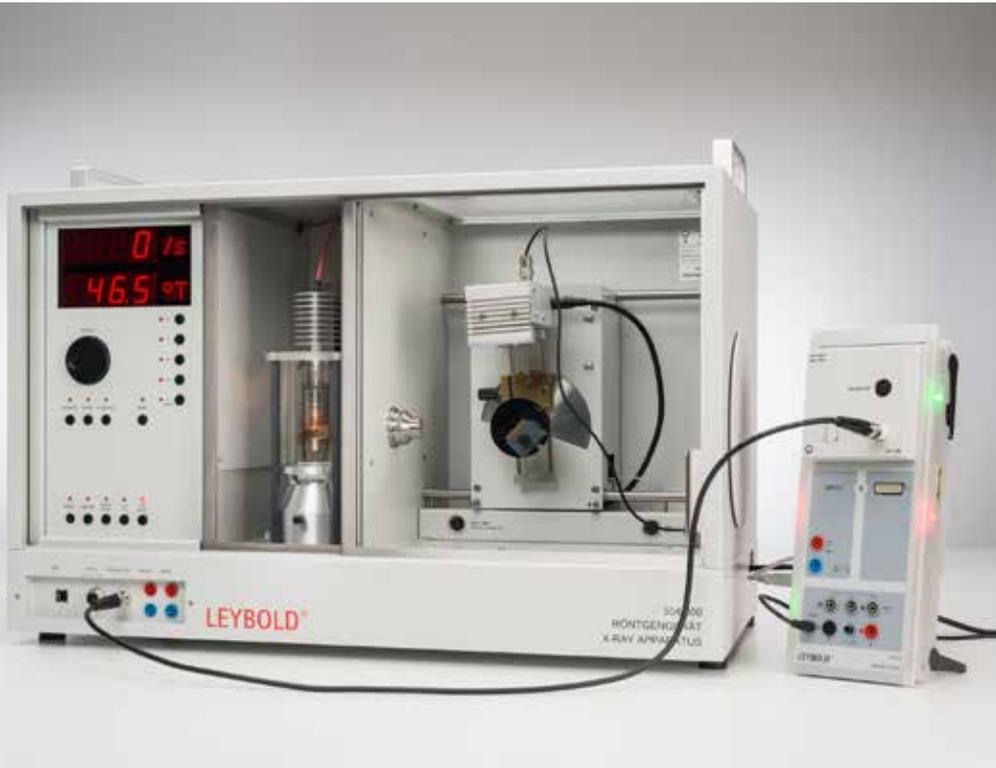
Application du fluorescence X pour l'analyse sans destruction de la composition chimique (P7.5.1.1)
