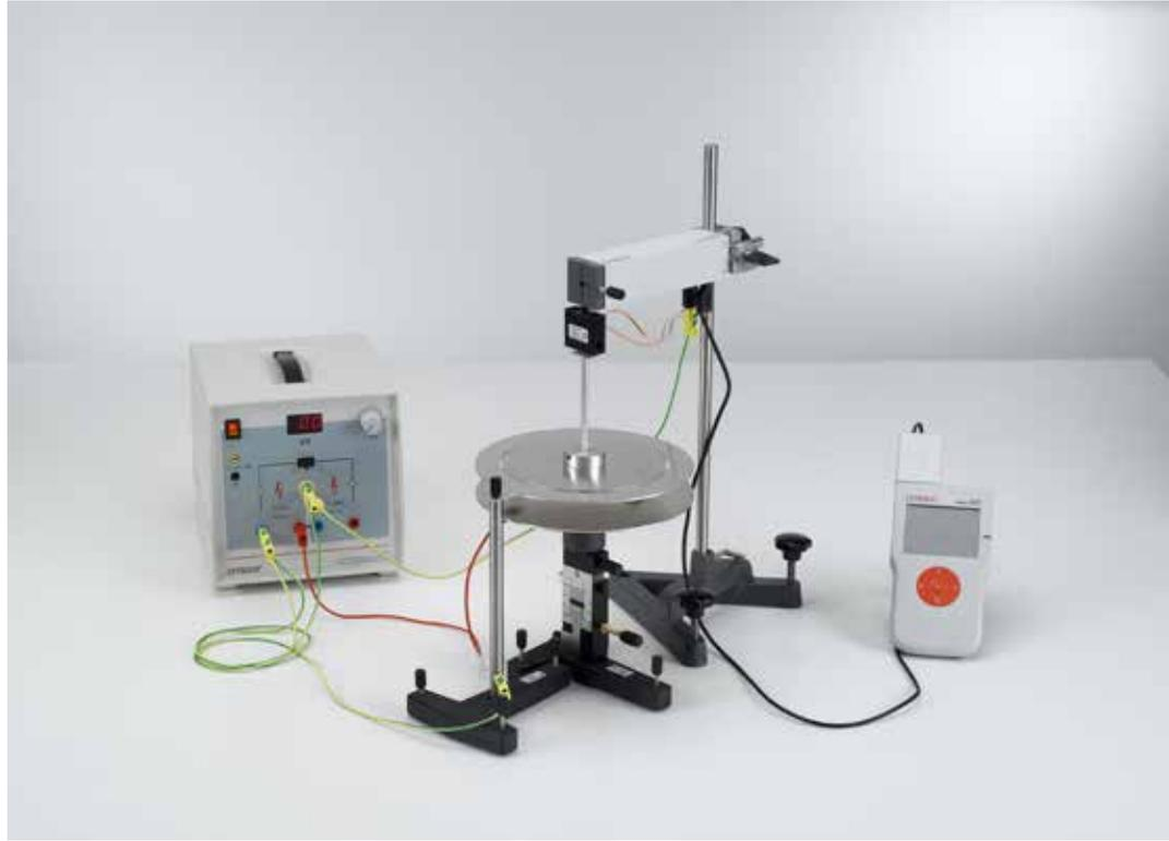
Electromètre absolu de Kirchoff: mesure de la force entre les plaques électrisées d'un condensateur - mesure avec le capteur de force (P3.1.4.2)
