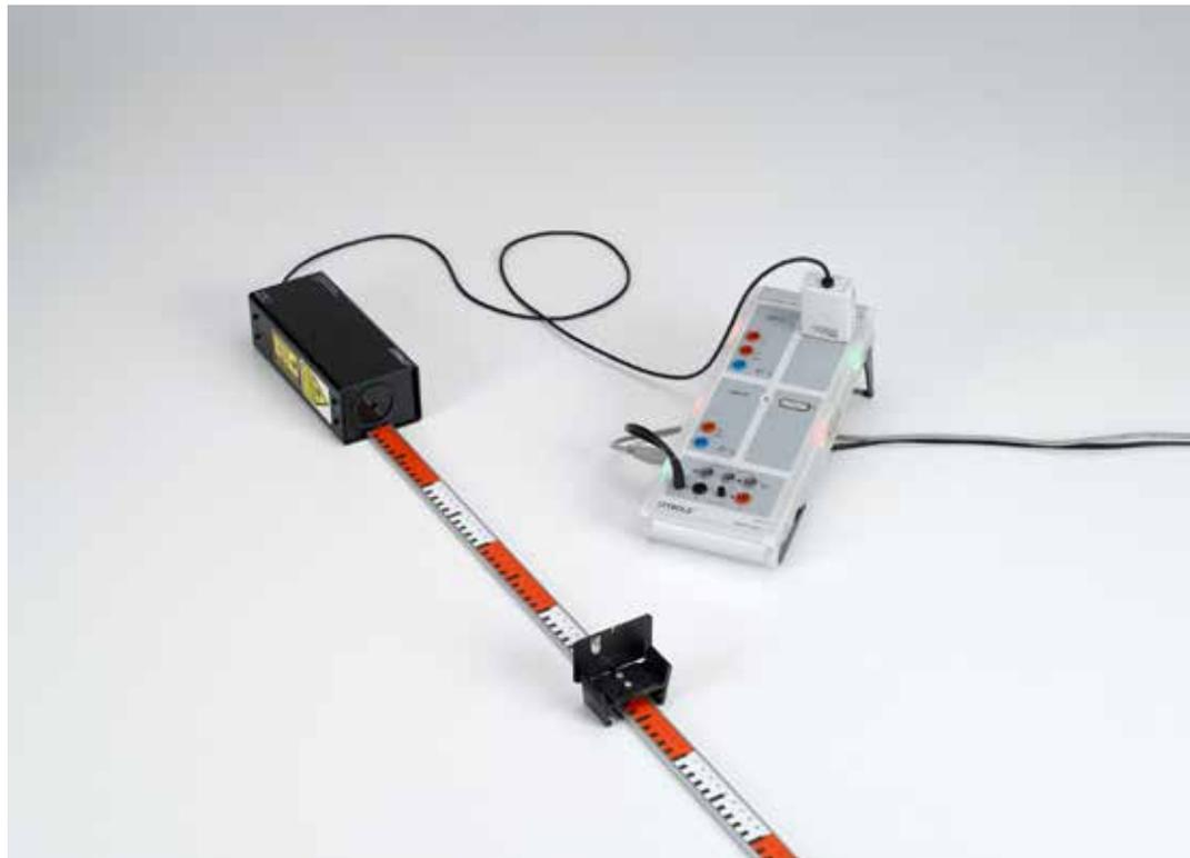
Détermination de la vitesse de la lumière avec un signal lumineux périodique sur une courte section de mesure - mesure avec un capteur de déplacement à laser et CASSY (P5.6.3.3)
