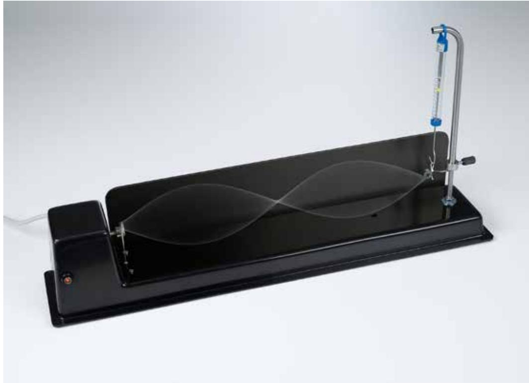
Etude des ondes d'une corde à polarisation circulaire dans le dispositif expérimental de Melde (P1.6.3.1)
