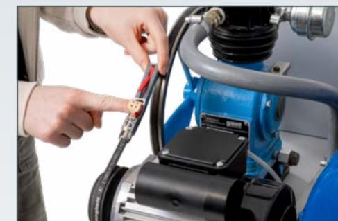
Contrôler la tension de courroie
