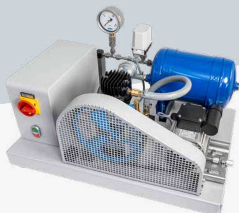
MT 142 Efficacité énergétique des compresseurs à piston
